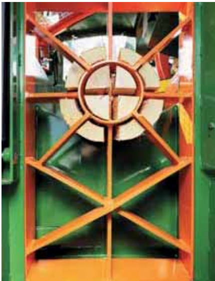
La lama di taglio speciale regolabile idraulicamente permette l'adattamento della legna a diversi diametri senza dover cambiare la lama.
