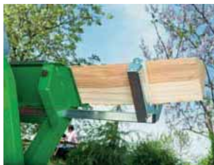
Prolungamento del tavolo inclinabile con rulli (F0002108) in modo da poter sostenere in modo sicuro anche pezzi spaccati più lunghi.
