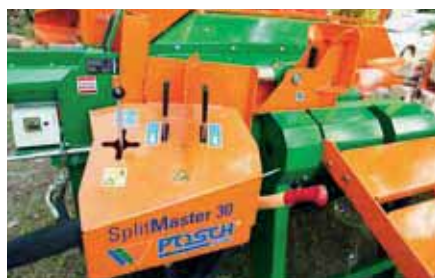
Controllo a due mani. Joystick per dispositivo di sollevamento e regolazione lama.
