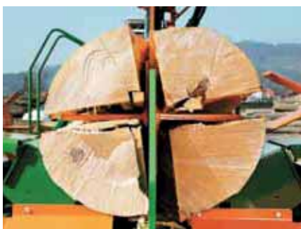
Lama di taglio regolabile in modo idraulico per una spaccatura potente della legna.
