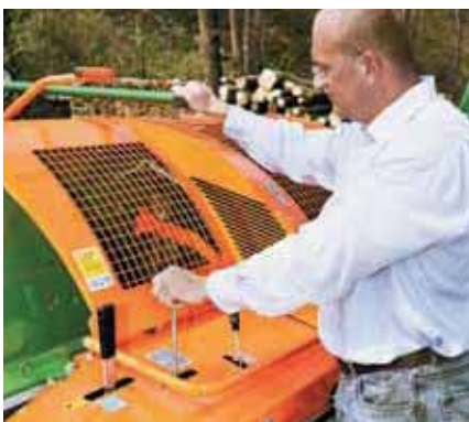
L'azionamento del dispositivo di mantenimento legna e della lama della sega avviene mediante avanzamento manuale ergonomico.
