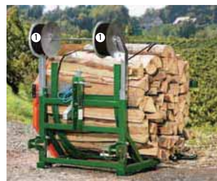
Sistema di affastellamento con nastro composito ❶ svolgitore per nastro composito
