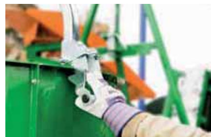
PackFix con sistema di cambio rapido: il tamburo di riempimento può essere staccato dal telaio grazie a una maniglia.
