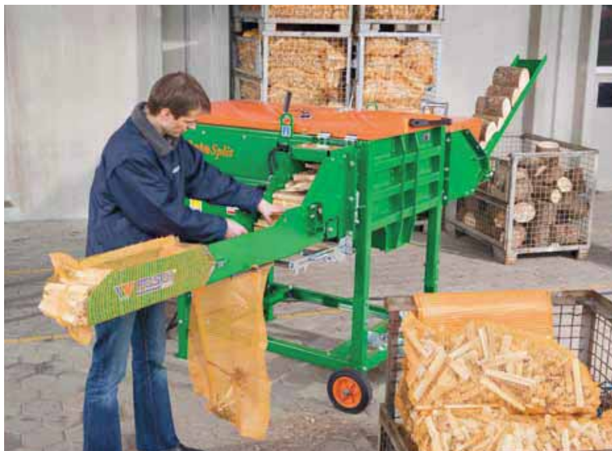
AutoSplit con canale per il confezionamento a strati
