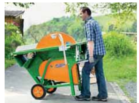
Trasporto semplice con ruote in gomma piena Ø 300 mm.
