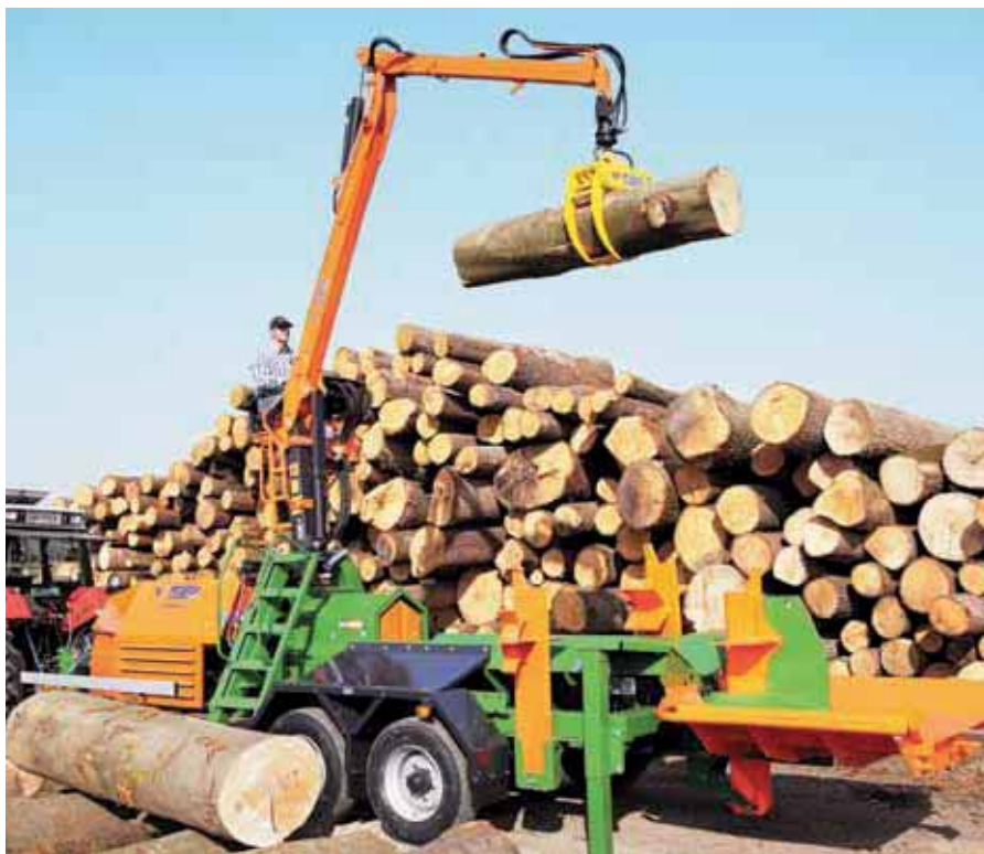
SplitMaster 55 Crane. La gru di carico solleva tronchi fino a un peso in 1.200 kg nella cassetta di taglio.
