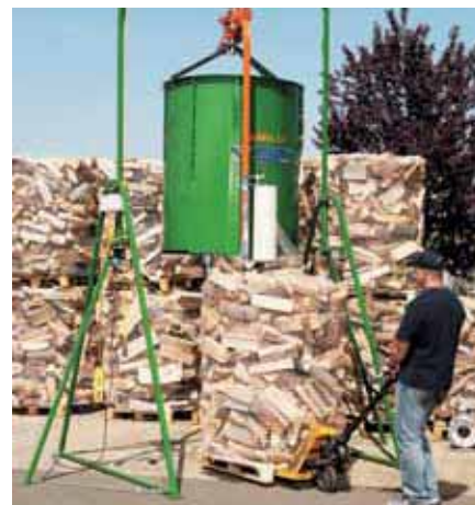
Canale di riempimento "Single/Duo" per alimentazione del PackFix con nastro trasportatore fisso.
