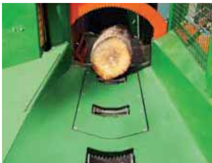
Cilindri alimentatori per un trasporto semplice.
