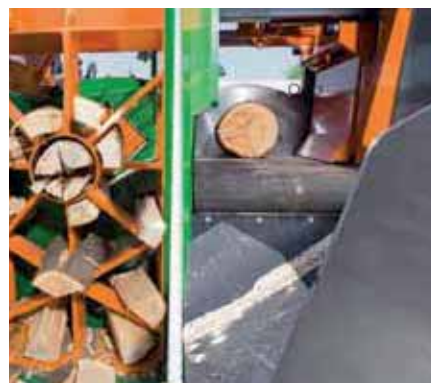
OnlyCut: possibilità di tagliare soltanto senza spaccare (O) come dotazione speciale.
