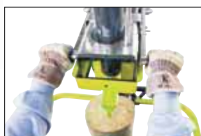
Dispositivo di accensione di sicurezza a due mani
