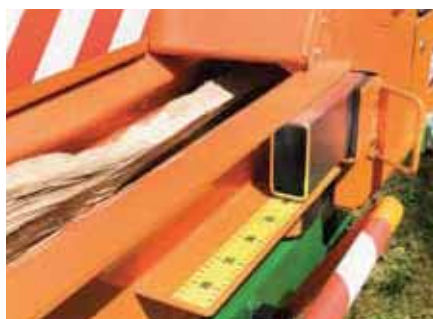
Regolazione continua della lunghezza della legna da 13 a 52 cm.
