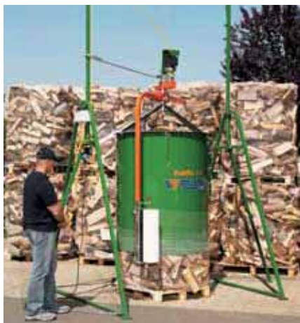
Il braccio rotante avvolge il tamburo di riempimento con il rotolo di rete.
