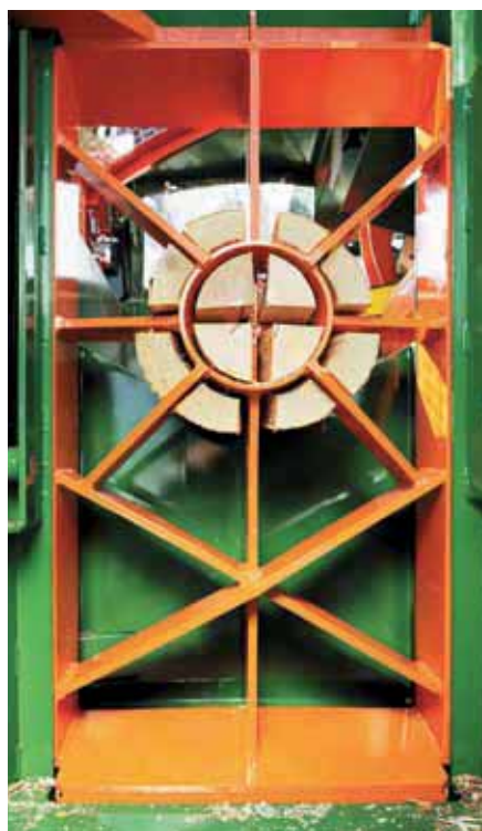
Lama di taglio speciale (F0002070) regolabile idraulicamente per 2,6 o 12 pezzi spaccati con Spaltfix K-450 Spezial.
