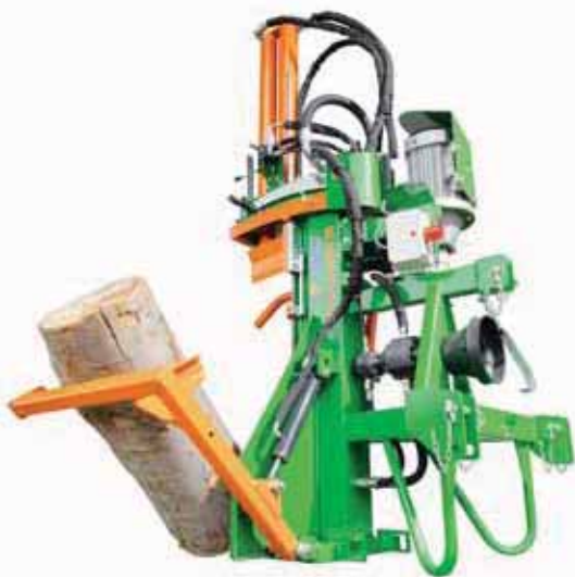
HydroCombi Turbo con dispositivo idraulico di sollevamento tronchi
