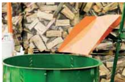
Dopo che il tamburo di riempimento è stato completamente tirato verso l'alto, il "pacco di legna" pronto può essere portato via.
