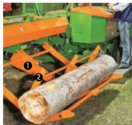
Dispositivo di sollevamento tronchi per lunghezza max. tronco 2,5 m ① Dispositivo di sollevamento tronchi, ② Pinza di supporto tronchi
