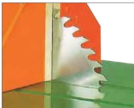
Lama per sega circolare in lega di cromo
