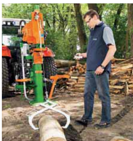
Argano WF con pinza e attivazione radio
