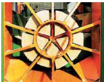
La lama di taglio (F0002182) può creare, tramite spaccatura, fino a 15 pezzi spaccati.
