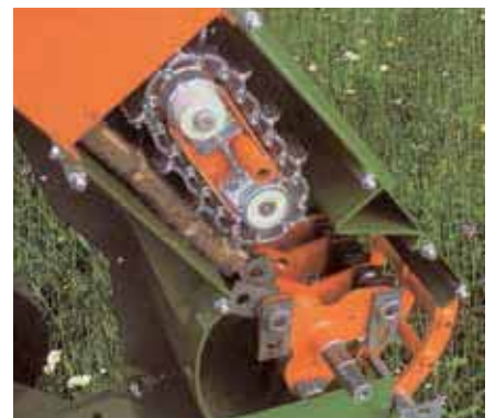
Funzionamento della cippatrice professionale Profihäcksler 300K1
