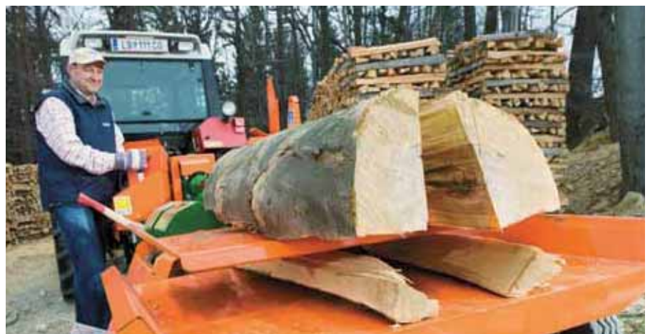
SplitMaster 20 opzione con lama di taglio "Easy" e carrello trattore tirato longitudinalmente.
