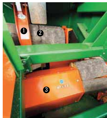
Il nucleo di Spaltfix K-540: benna doppia ❶, testa della sega Harvester con tensione idraulica della catena e della lama ❷. L'elemento di pressione ❸ spinge il legno con una forza di 35 t contro la lama a doppio taglio.
