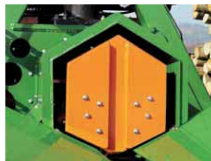
Il cilindro spinge il materiale da spaccare con più di 40/55 t attraverso la lama di taglio.
