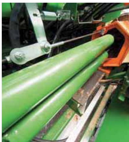
Potente e veloce. Il sistema a due cilindri permette una corsa di ritorno due volte più veloce e dunque un rendimento orario superiore.
