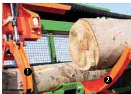
Avanzamento legna tramite benna doppia con contemporanea funzione di mantenimento legna ❶ e manipolatore tronchi ❷.
