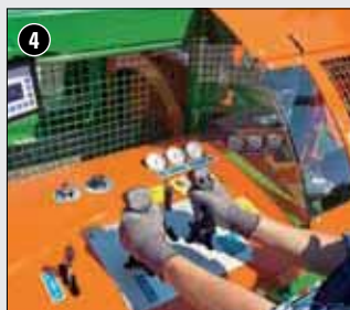
4 Comando semplice e confortevole della macchina tramite joystick ad una mano o a due mani.
