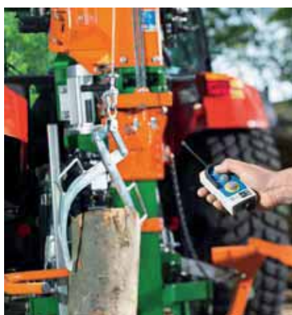
Argano WF con attivazione radio
