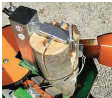
La sospensione a tre punti per Spaltaxt 8 (F0002576) riesce a lavorare senza fatica e in modo razionale quattro pezzi spaccati in un'unica fase di lavoro.
