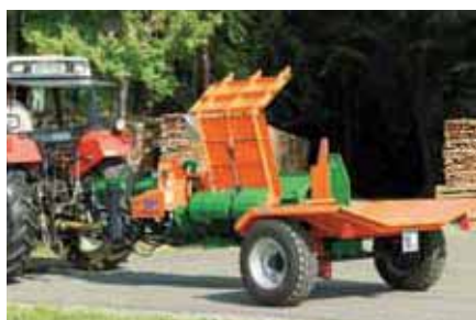
La SplitMaster 30 con carrello trattore tirato longitudinalmente per un impiego in movimento.
