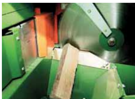
Il fissaggio automatico della legna assicura un taglio sicuro.
