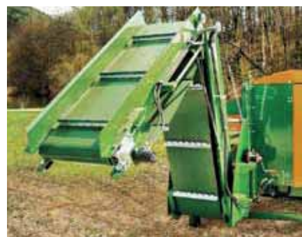
Il trasportatore a nastro inclinabile opzionale può essere comodamente ribaltato sulla macchina.
