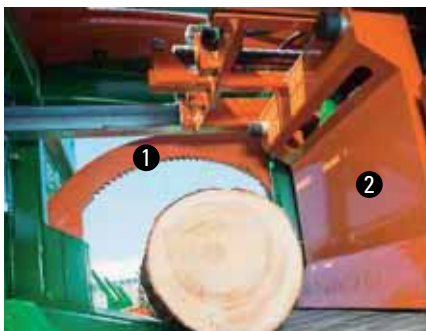
Dispositivo di mantenimento ❶ con cassetto di distribuzione legna ❷ per il trasferimento della legna alla spaccatrice.
