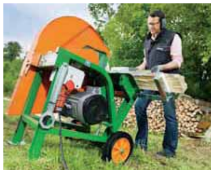
Sega con tavolo inclinabile con azionamento a cinghie trapezoidali e prolungamento tavolo inclinabile opzionale (F0002108)
