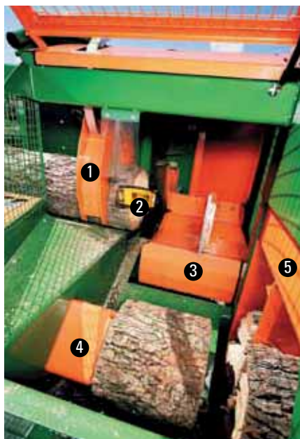
Il nucleo di Spaltfix s-440: Benna doppia con visualizzazione Ø legna ❶, sega a catena Harvester con lunghezza della lama 75 cm ❷, tavolo idraulico inclinabile ❸, che durante il taglio "sgombera" automaticamente e trasporta il legno nel cassetto di taglio. Un cilindro di grandi dimensioni ❹ preme la legna con una forza di 18 t attraverso la lama a doppio taglio ❺.
