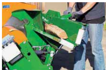
CutMaster Comfort: comodo taglio del legno con rulli di presa grandi sul tavolo inclinabile.
