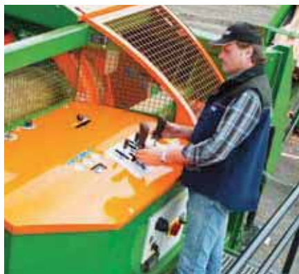
Spaltfix K-540 si controlla tramite un comando con joystick a due mani.
