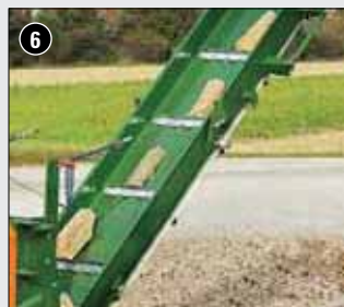
6 Nastro trasportatore e trasportatore a nastro inclinabile in opzione per caricare comodamente i pezzi spaccati pronti.
