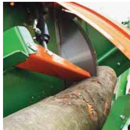
Il dispositivo idraulico e automatico di mantenimento legna
