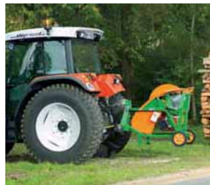
La sega con tavolo inclinabile GS con azionamento tramite presa di forza si trasporta in maniera comoda e veloce nel luogo di impiego grazie alla sospensione a tre punti.
