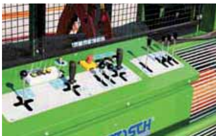
Spaltfix K-550 si controlla tramite un comando con joystick a due mani di serie.
