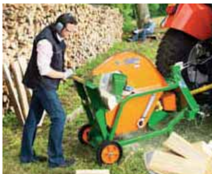
Sega con tavolo inclinabile con azionamento tramite presa di forza per impiego in movimento
