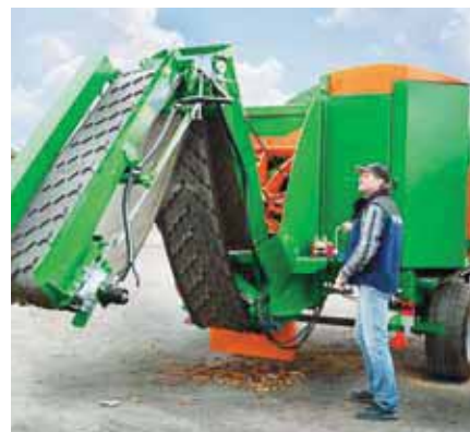
Il trasportatore a nastro inclinabile opzionale è disponibile in 4 m o 6 m di lunghezza. In posizione di trasporto si ribalta in modo semplice e in poco spazio sulla macchina.
