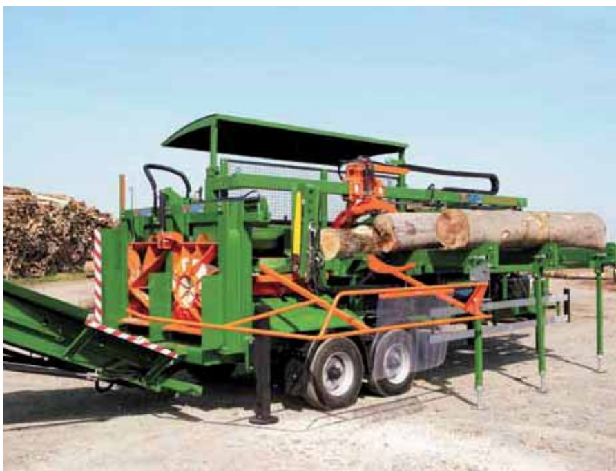
Spaltfix K-550 con trasportatore trasversale e nastro trasportatore come dotazione aggiuntiva.
