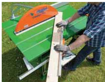
Arresto trasversale di precisione con piano scorrevole dotato di cuscinetto a sfera (F0002214).
