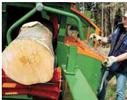
Il manipolatore porta il legno, al momento dell'inserimento, in posizione ottimale.
