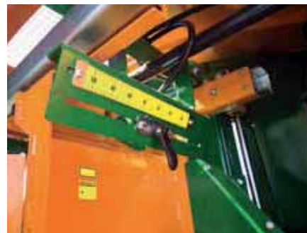
La misura della lunghezza della legna è impostabile in maniera continua tramite un sensore ottico.
