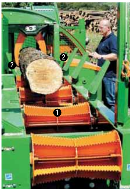
Il trasportatore a rulli opzionale ❶ incl. manipolatore (di serie) ❷ trasporta la legna alla sega a catena Harvester 75 cm.
