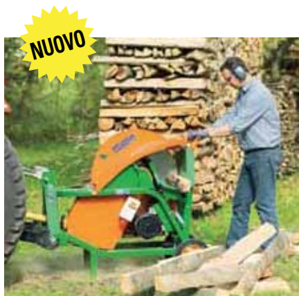
Taglio della legna da ardere tramite sega con tavolo inclinabile GS con azionamento tramite presa di forza.
