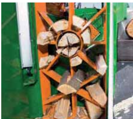
Lama di taglio speciale (F0002070) per 2, 6 e 12 pezzi spaccati in un unico ciclo di lavoro.
