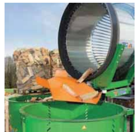
Scivolo per legna a pezzi spaccati (F0002668) per il riempimento continuo di due tamburo di riempimento PackFix
