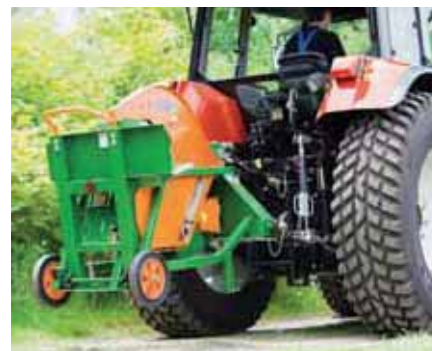
La sega con tavolo inclinabile si trasporta in maniera comoda e veloce nel luogo di impiego grazie alla sospensione a tre punti.
