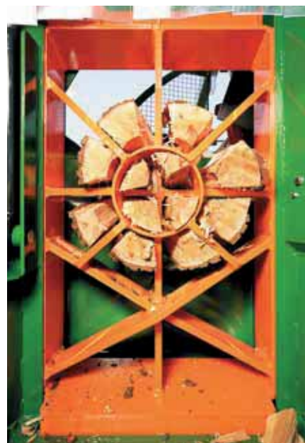
La lama di taglio speciale 2-6-12 (F0002844) permette l'adattamento della legna a diversi diametri senza dover cambiare la lama.
