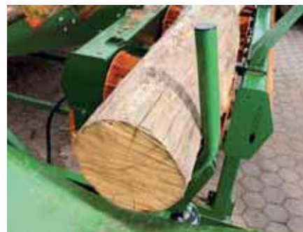
Manipolatore tronco per il trasporto ottimale.
