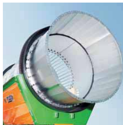
Tubo di prolungamento (F0002667) ad es. per PackFix Hydro con tavolo orientabile (ST)
