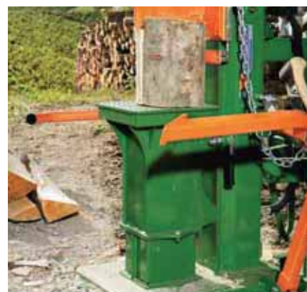
Banco di appoggio legno regolabile in altezza (F0002538 o F0002564) per la spaccatura di legna corta (35/55 cm).
